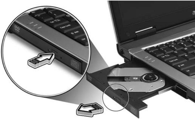
若在電腦電源關閉時，您可將迴紋針插入緊急退出孔來退出光碟機托盤。
