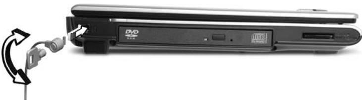
將電腦安全鎖電纜線繞著無法移動的物品打個圈，例如，桌子或鎖住的抽屜把手。再將鎖插入插槽中，並轉動鑰匙以便上鎖。另外一些沒有鑰匙鎖孔的機型，也可提供使用者來選擇。
