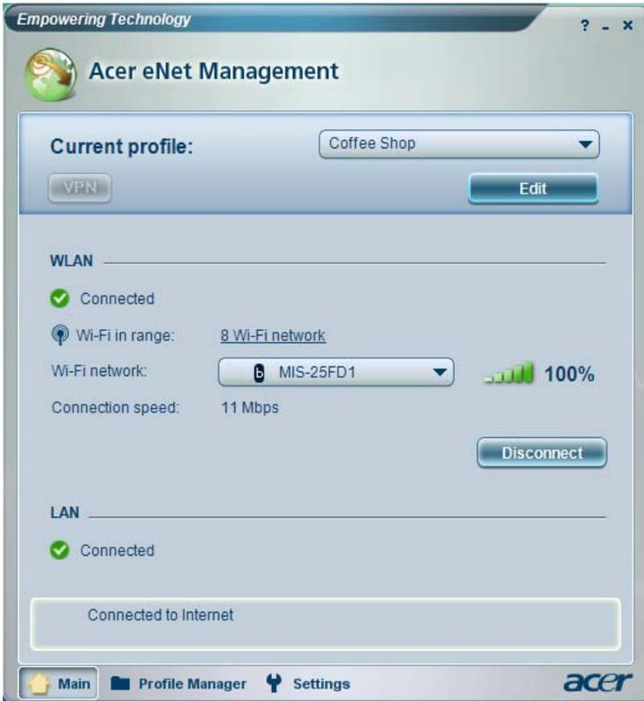
Acer eNet Management 可以將各個場所的網路設定儲存成設定檔，當您移動至不同的地點時可以自動套用適合的設定檔。設定的儲存內容包括網路連線設定 (IP 及 DNS 設定、無線 AP 詳細資料等)，以及預設印表機的設定。基於安全性的考量，Acer eNet Management 並不儲存使用者名稱及密碼等資訊。
